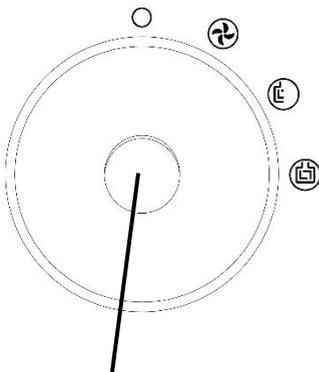
1. Pomo de ajuste de la potencia de funcionamiento
